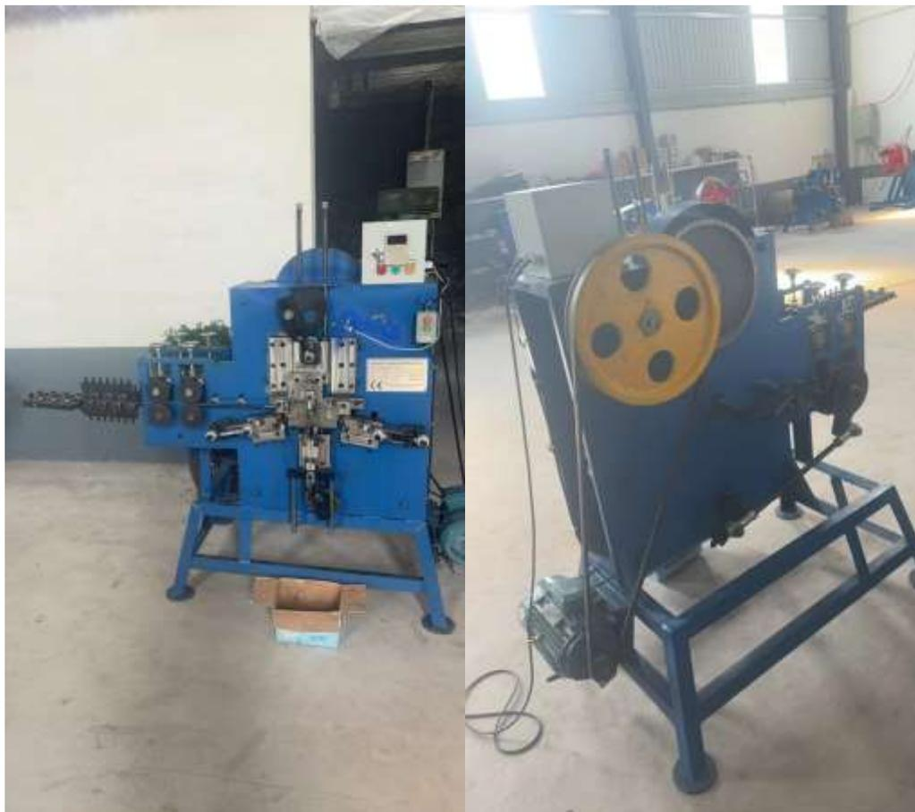
П р и м е н е н и е машины: используется для изготовления проволочной пружки 19 мм для лент из композитного волокна.
